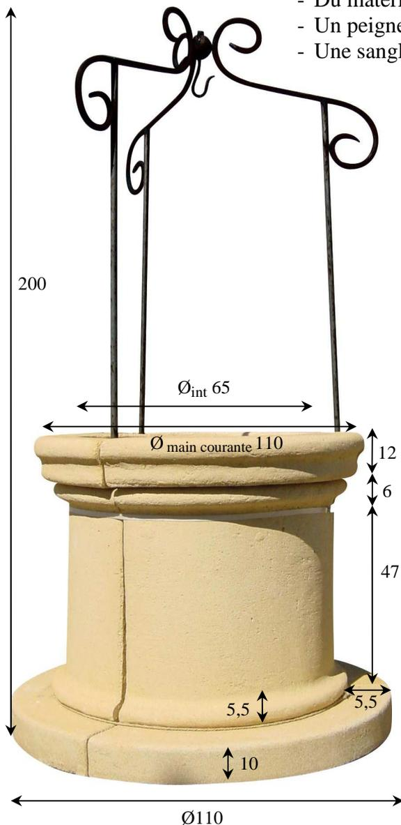
**⚠** Le puits doit être posé sur une dalle de béton de 8 à 12cm d'épaisseur sur sol stabilisé, dosée à 300 KG/m<sup>3</sup> avec armature de treillis soudé. Le sol sera décapé de toute terre végétale, nivelé et éventuellement consolidé et assaini avant d'être compacté. Si nécessaire, prévoir une sous-couche de tout venant. Dans tous les cas, ne pas réaliser de dallage sur un remblai récent, non compacté.
